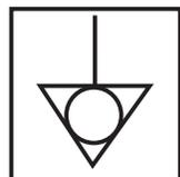
O símbolo acima indica o terminal de ligação equipotencial, destinado à ligação do equipamento via condutor elétrico a outros pontos de ligação equipotencial, tais como equipamentos, bancadas, edificações, mantendo-se deste forma o equilíbrio entre diferentes pontos de ligação, minimizando possíveis riscos de choque elétrico. Este terminal permite a conexão de um cabo de seção nominal de 10mm<sup>2</sup>.
